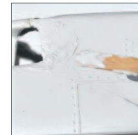
**5** Das Gelcoat wird mit einer kleinen Spachtel oder einem Holzspatel auf die beschädigte Oberfläche aufgetragen und grob geglättet.
