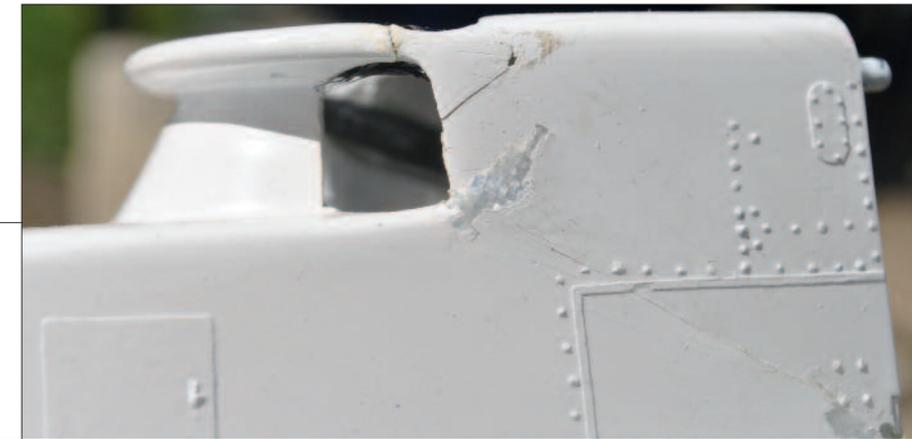
Besonders einfach ist die Reparatur bei einfarbigen Hauben oder an Stellen des Rumpfs, an denen kein Farbübergang in der Lackierung vorhanden ist. Besonders problemlos sind natürlich weiße Hauben und Rumpfe. Als erstes Beispiel soll ein kleiner Scale-Rumpf mit leichten Beschädigungen in der Deckschicht dienen. Dank der überwiegend weißen Lackierung kann hier besonders einfach nachgebessert werden.
