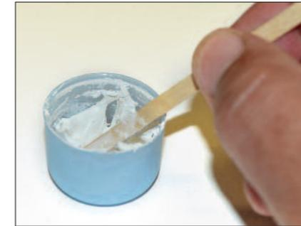
**3** Das Gelcoat wird in kleinen Mengen mit dem zugehörigen Härter angerührt. Normalerweise werden hierbei 2% Härter hinzugefügt.
