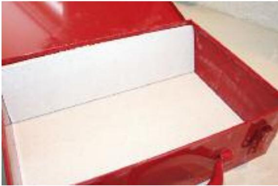
Der Boden ist drin – nun wird die erste Längsseite eingepasst. Wie im Text zu lesen, würde diese an der Scharnierseite beim erneuten Bau eines solchen Koffers wegen der »Deckelproblematik« aufgedoppelt!
