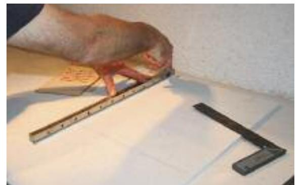
Nach dem Anreißen kann die Platte einfach über einen Holzstab gebrochen werden.
