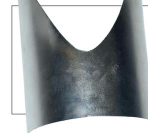
3 Das Blech wird mit einer scharfen Schere entsprechend der Papierschablone ausgeschnitten. Anschließend werden die scharfen Schnittkanten mit Schleifpapier entgratet.
