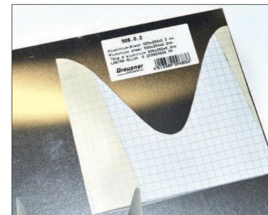
2 Das Papiermodell wird an der Rückseite aufgeschnitten und als Schablone auf das Alublech (0,2 mm) gelegt.
